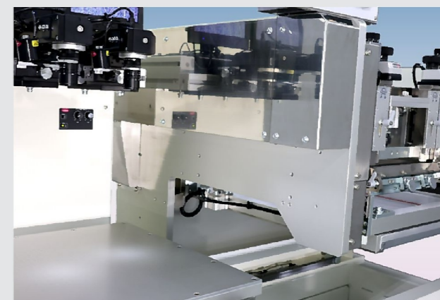
駆動部の露出を極限まで抑えステンレスカバーで防塵対策をしたクリーンな本体。
