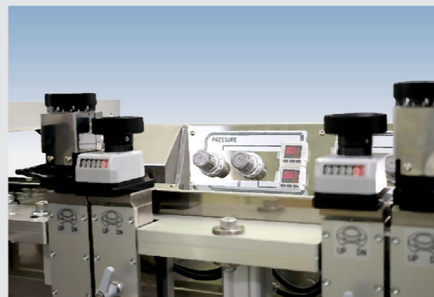
総印圧は細かく制御でき、背圧の調整もできる。
